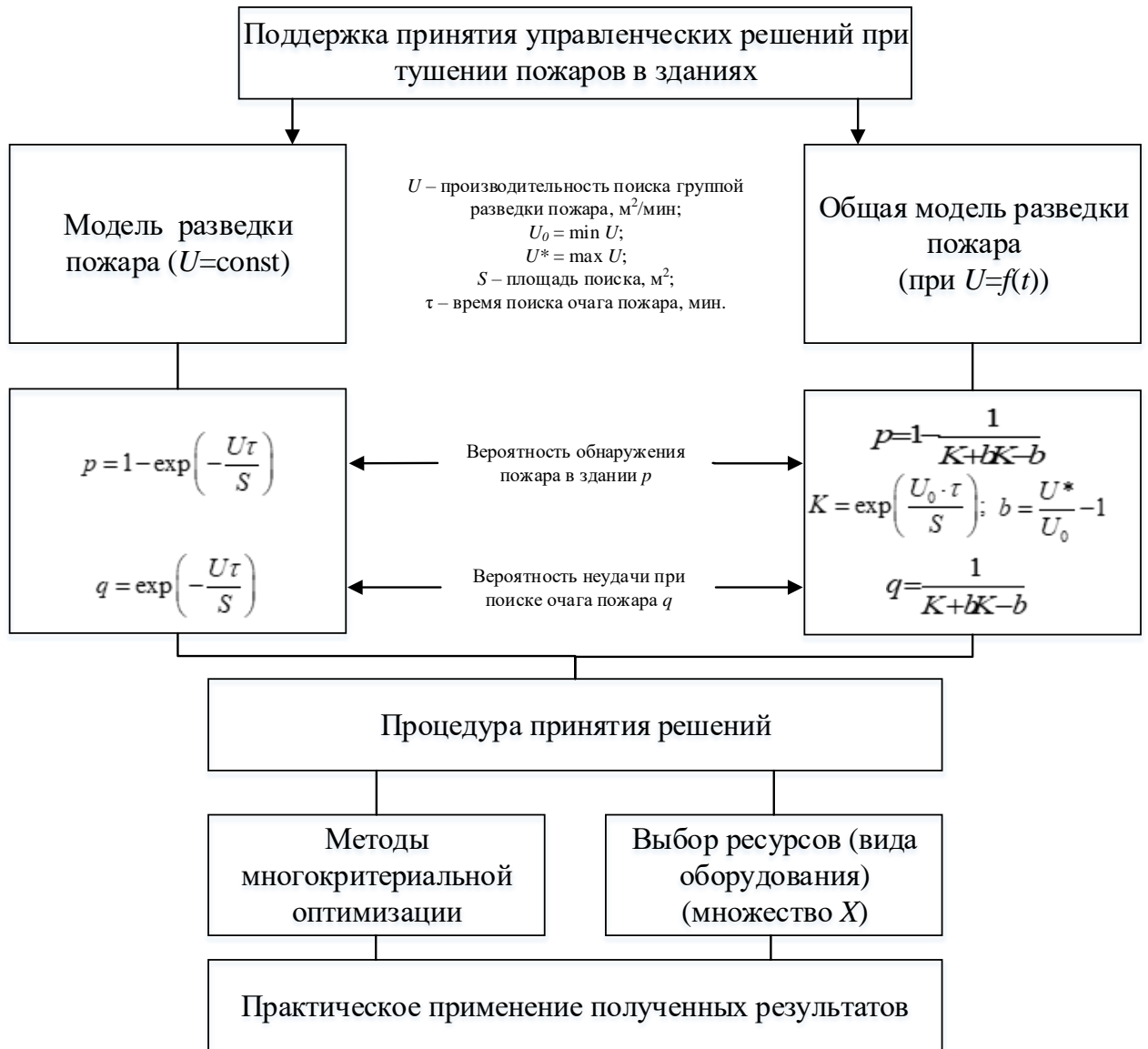
Рисунок 2.6 – Структурная схема поддержки принятия управленческих решений при тушении пожаров в зданиях
