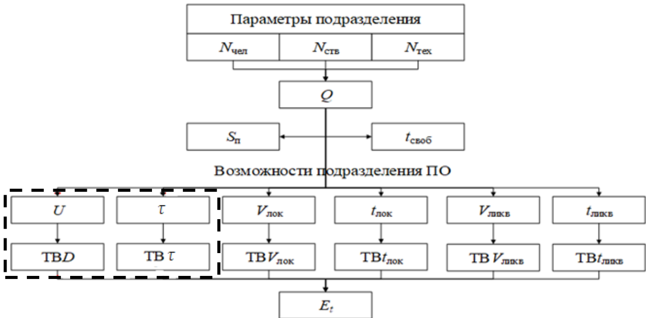
Рисунок 1.12 – Схема определения тактических возможностей пожарных подразделений при тушении пожаров в зданиях
